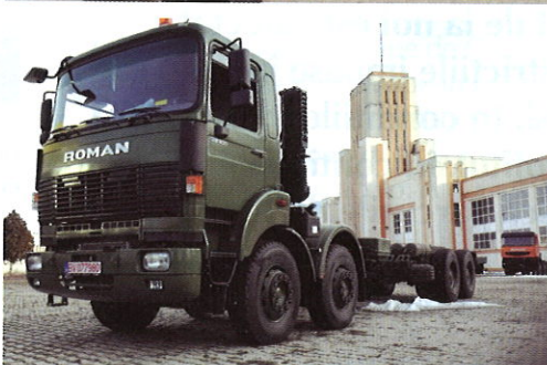
Roman a livrat la începutul lui 2017 în Taiwan două autocamioane 8x4 pentru transport de containere, cu motor MAN Euro 5 de 400 CP, transmisie automată Allison 4000, masă totală de 38 t, echipate cu sistem hook loader
